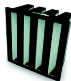
Absoluutfilter HEPA Afscheiden van aerosols, bacteriën en virussen Filterklasse H10–H13
