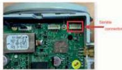
2/ Sluit de connector aan op de 'eVAV' poort van de elektronische kaart
