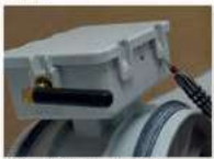
1/ Open de behuizing met een platte schroevendraaier door de 4 bevestigingspijpen los te maken
