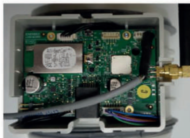
3/ Leid de kabel door het grootste gat in de doos
