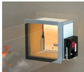
Er breekt brand uit en de temperatuur stijgt naar 72°C: het smeltlood smelt en het klepblad sluit.
